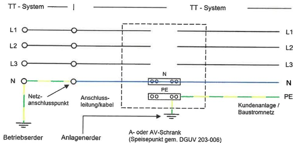
Abbildung 8 - Anschlussmöglichkeiten am Beispiel des TT-Systems
